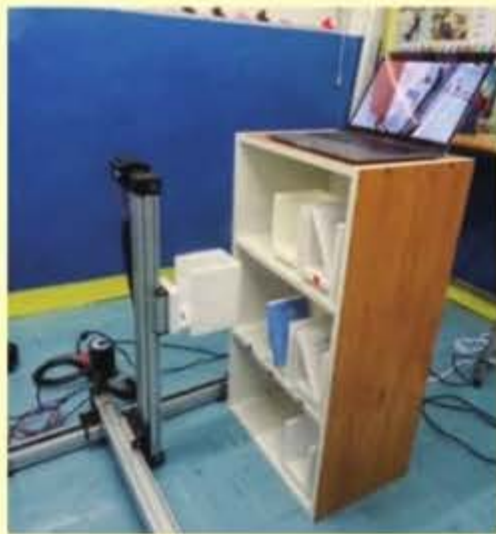
● 提書籃利用3D打印出來，再上螺絲與機械結合。
